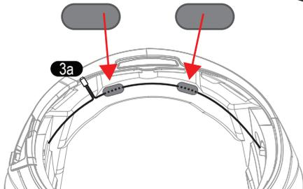
Mettere il cavo microfono/altoparlante sul retro dell'EPS inferiore facendo riferimento alla foto qui sopra. È possibile riordinare fissandolo con il velcro ellittico.
