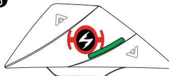
Premi il pulsante Accensione su qualsiasi dispositivo EXO-Com per avviare il processo di accoppiamento. L'unità lampeggerà in verde una volta collegata.
