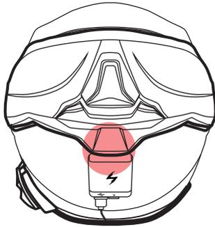
Per EXO-Tech Carbon, controlla se c'è abbastanza spazio tra la mentoniera e il vano batteria.
