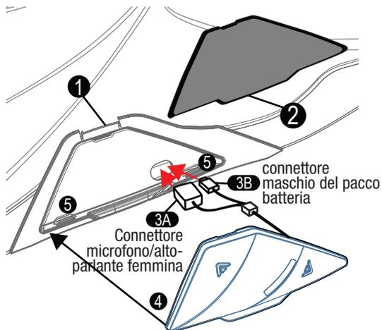
Spingere verso l'alto la leva di blocco (1) per rimuovere la Copertura del Controller EXO-COM (2), e mettere il connettore microfono/altoparlante femmina (3A) prima nel foro e poi nel connettore maschio del pacco batteria (3B) facendo riferimento all'immagine qui sopra.
