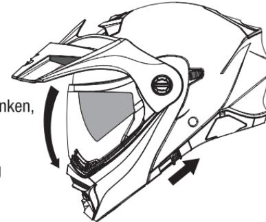
Um die Sonnenblende zu senken, schieben Sie einfach den SpeedView® Sonnenblende Rückzugs-Hebel in Richtung der Rückseite des Helms.
