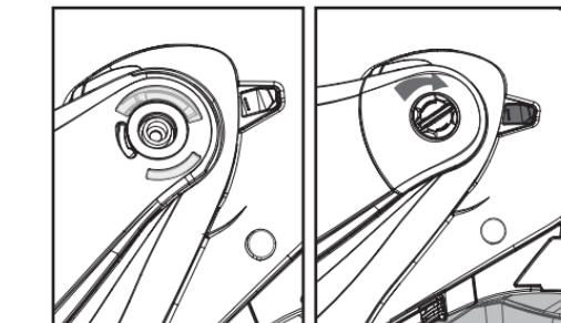
Para instalar las tapas laterales, primero quita la visera. Despues alinea la tapa de cada lado con la visera ( ver flecha gris) y con el agujero del tornillo de la visera.
