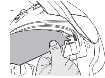
Tout en maintenant l'écran solaire rétractable d'une main, sortez l'écran solaire de ses attaches et retirez-le du support latéral.
