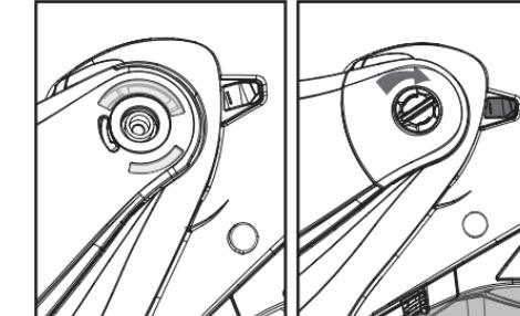
Para instalar as tampas laterais primeiro remova a pala. Depois alinhe a tampa lateral com o lado da viseira e com o furo do parafuso.
