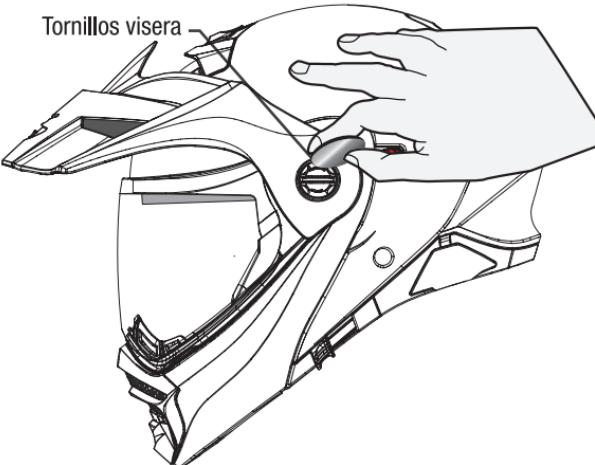
Una vez que la nueva pantalla esté en posición, reinstale la visera o las tapas laterales.
