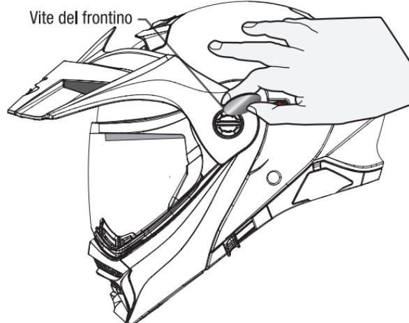
Una volta che la nuova visiera è in proprio posizione, reinstallare il frontino o cover laterali.
