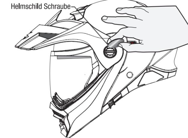
Wenn das neue Visier in Position ist, dann können Sie das Helmschild und die beiden seitlichen Deckel montieren.
