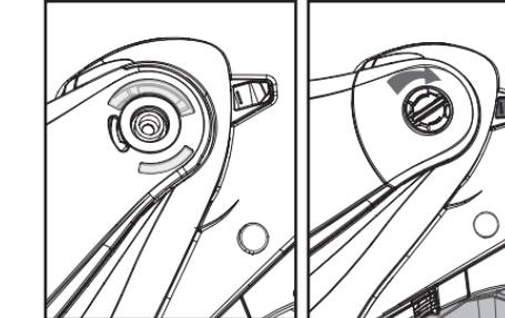
Um die seitlichen Deckel zu installieren, nehmen Sie erst das Helmschild ab. Dann bringen Sie beide seitlichen Deckel in einer Linie mit der Visierplatte und dem Loch der Helmschild Schraube.
