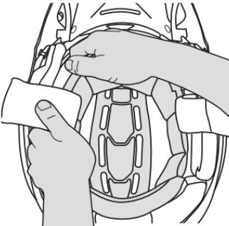
Cuidadosamente, extraer las almohadillas interiores de las paredes del casco descorchando los tres clips de plástico de cada lado. Despues, extraer el contorno con sus almohadillas fuera del casco.
