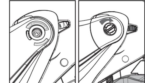
Per installare la cover laterale allineare la cover, rimuovere il frontino poi allineare le cover nell'alloggiamento come indicato dalla freccia grigia in modo che si allineino anche i fori delle viti. Inserire le viti e avitarle accuratamente con un attrezzo (come una moneta).
