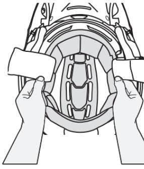
Nachdem die beiden Wangenpolster herausgenommen sind, fassen Sie das Kopfpolster in der Nähe des Hinterkopfs und ziehen es in Richtung Augenausschnitt, um es aus den Kunststoffschnappern zu lösen. Nachdem es aus den Schnappern gelöst ist, ziehen Sie vorsichtig am Kopfpolster, um es aus der Einspannrolle auf Stirnhöhe zu lösen.
