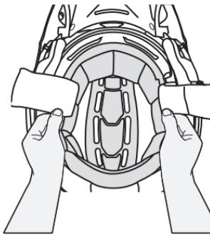
Após remover as almofadas interiores laterais, puxe o forro interior conforme imagem abaixo. A parte fontal do forro está presa à estrutura do capacete.
