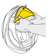
El Aero Skirt ha diseñado para reducir la entrada del viento detrás del área de la pantalla, para mantener caliente la cara en un clima frío.
