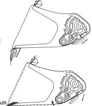
Per bloccare la visiera, girare la leva di bloccaggio in senso antiorario, all'incirca fino alla posizione di ore 2. Testare ora la visiera per verificare che sia bloccata correttamente.
