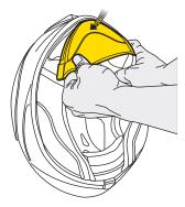
Il coprimento aero skirt è stata progettato per ridurre le infiltrazioni d'aria e, in particolare, per mantenere lavostra testa al caldo durante i periodi freddi.
